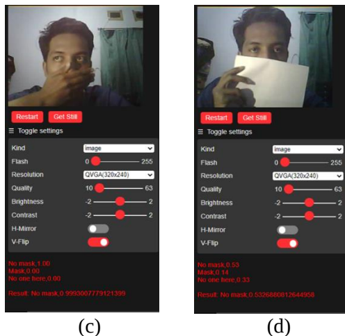
Gambar 8. Hasi uji pada personil yang menutup wajah bukan dengan masker pada ESP32-Cam
