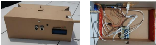
Gambar 5. Prototipe Modul Pendeteksi Masker Wajah dan Suhu Tubuh Manusia
