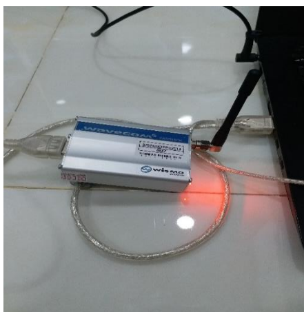
Gambar 13. Modem Wavecom Sebagai Alat SMS Gateway
